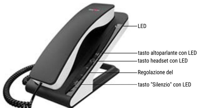
La regolazione del volume avviene con i due tasti "più" e "meno". La regolazione del volume produce il suo effetto sul dispositivo (headset, microtelefono e altoparlante) scelto per la diffusione della conversazione. Il tasto "Silenzio" attiva o disattiva il microfono usato per condurre la conversazione. Il tasto headset attiva la modalità headset. Il tasto "Diffusore" attiva l'altoparlante.
