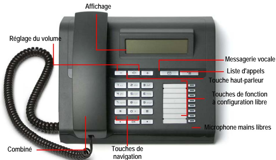
Fig. 5-1: Éléments de commande de SwyxPhone L615
