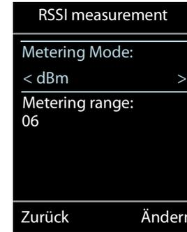
•dBm: die gemessene Signalstärke wird in dBm angezeigt. Dies ist der voreingestellte und empfohlene Modus.
