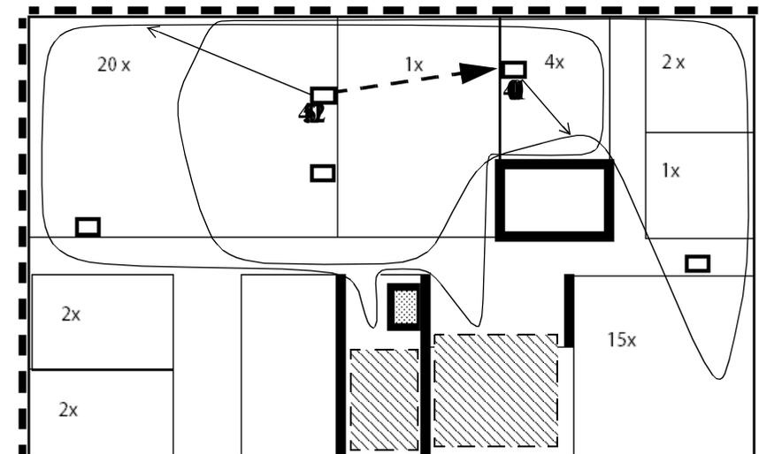
Im Beispiel sind für die Basisstationen A und D Begrenzungslinien für die Funkabdeckung eingezeichnet. Die Überlappungsbereiche sind für beide Stationen sehr gut, die Synchronisation zwischen A und D ist ebenfalls gewährleistet. Es muss jedoch anhand der Messergebnisse der weiteren Stationen geprüft werden, ob in den schraffierten Bereichen jeweils eine weitere Basisstation erforderlich ist.
